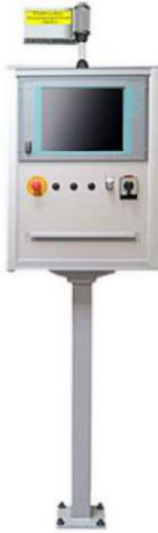
Rys. 3. Przykładowe rozwiązanie kompleksowego panela HMI do obsługi stacji.
